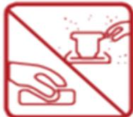
Lixar com lixa 80 ou 150. Em seguida limpar a peça com Solução Desengraxante Maxi Rubber removendo toda oleosidade, poeira, corrosão e água.
